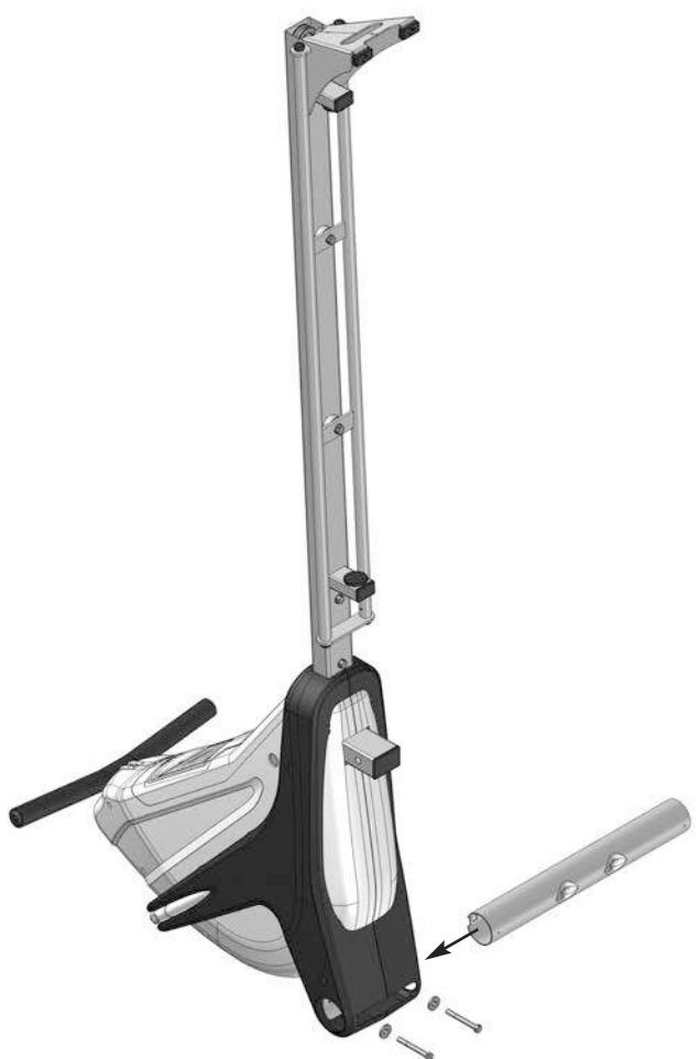
2x M8x70 mm  $\varnothing 25 \times 8,4 \text{ mm}$
