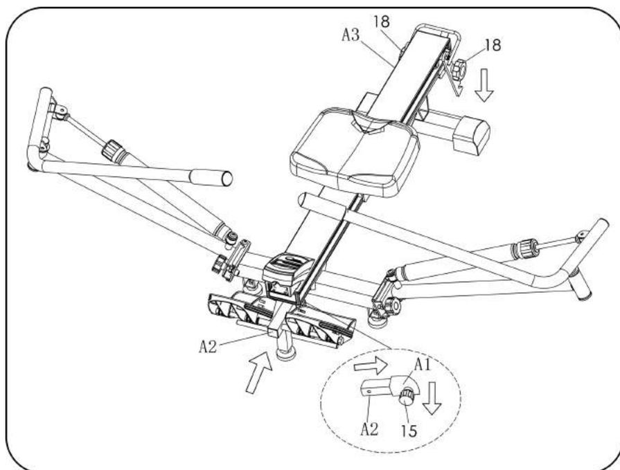
1. Le groupe de réglage de pédale (A2) est replié : desserrer d'abord la goupille de traction (15) du groupe de base (A1), puis tirer vers le bas tout en poussant le groupe de réglage de pédale (A2) dans le sens des flèches. Lorsque la goupille de blocage peut être insérée dans l'ensemble de réglage de la pédale (A2), serrer la goupille de blocage (15).
