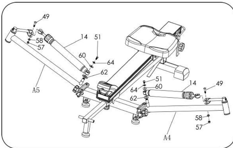
Utiliser une clé Allen (42), une clé multifonctions (43), une vis à tête hexagonale (49) et un écrou de blocage (57) à patin plat (58) ; la vis à tête (51), le patin à ressort (64) et la rondelle plate (60-62) pour le montage du cylindre (14) sur le groupe culbuteur gauche (A4) et le groupe culbuteur droit (A5), puis verrouiller.
