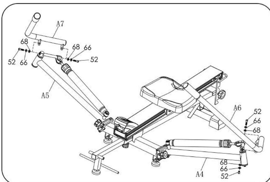
1. Utiliser la clé Allen (70) avec les vis hexagonales à tête plate (52) et le tampon plat (68) du patin de ressort (66) pour installer le groupe culbuteur gauche (A6) dans le raccord gauche (A4) ; installer le groupe culbuteur droit (A7) dans l'articulation du culbuteur droit (A5) puis verrouiller le tout.
